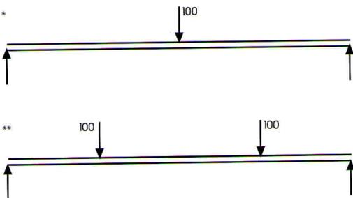
\*Esta separación máxima está calculada para una carga de 100 kg aplicada al centro del claro en el ancho total de la lámina (90 cm).
